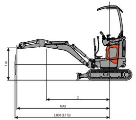
Hebekraft basierend auf ISO-Norm 10567 und überschreitet nicht mehr als 75% der Kippplast oder 87% der hydraulischen Hebe-Kapazität der Maschine.
