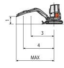
Hebekraft basierend auf ISO-Norm 10567 und überschreitet nicht mehr als 75% der Kipplast oder 87% der hydraulischen Hebe-Kapazität der Maschine.
