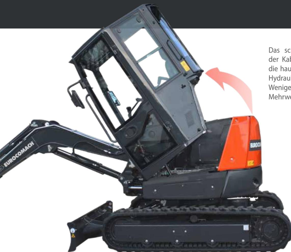
Das schnelle und praktische Kippen der Kabine erlaubt, den Verteiler und die hauptsächlichsten Komponenten der Hydraulikanlage bequem zu erreichen: Wenige Gesten für einen wichtigen Mehrwert.
