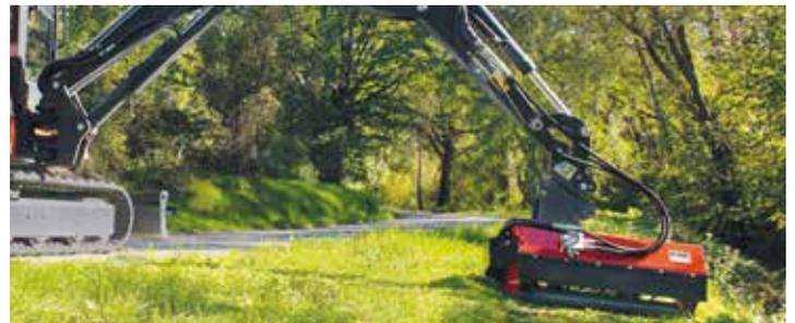
Hydraulikanlage, einfach/doppelwirkend mit elektrischen vorgesteuertem Nachlass (50 l/Min.)
