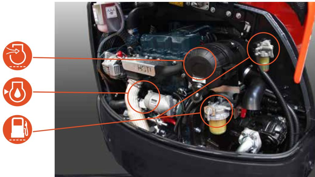
Alle Zugangspunkte für die täglichen Kontrollen und für die Eingriffe der ordentlichen Wartung sind in bestimmten Bereichen konzentriert, um eine Optimierung der Ausfallzeiten zu ermöglichen.
