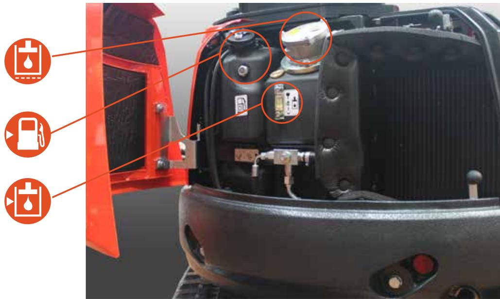
Die Betriebsfunktionen des Verbrennungsmotors sind bequem durch eine große Öffnung der seitlichen Klappe erreichbar. Alle Filter (Dieselmotortank, Öl und Luft), sind außer der Kontrolle und dem Nachfüllen des Motoröls leicht auf dieser Seite erkennbar.
