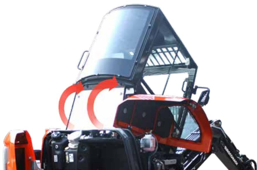
Die erleichterte ordentliche Wartung vereinfacht die Vorgänge des Kundendienstes. Die Heckklappe ermöglicht die einfache Reinigung des Kühlers und den Zugang zu Öl- und Dieselmotortank.
