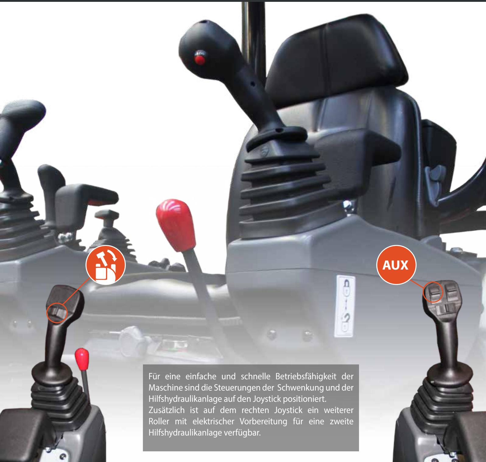
Für eine einfache und schnelle Betriebsfähigkeit der Maschine sind die Steuerungen der Schwenkung und der Hilfshydraulikanlage auf den Joystick positioniert. Zusätzlich ist auf dem rechten Joystick ein weiterer Roller mit elektrischer Vorbereitung für eine zweite Hilfshydraulikanlage verfügbar.
