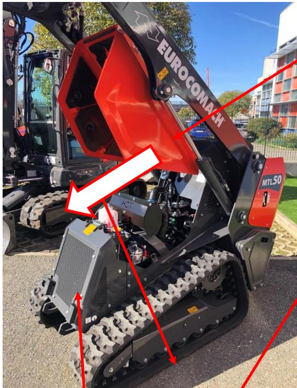
**Optimierte Kühlung mit Gebläserichtung nach vorne bzw. nach Assen, auch optimal für Einsatz mit Mulcher, Fräse und Kehrmaschine**
