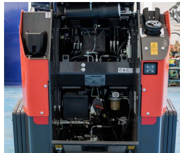
Hinterer Zugang zu Batterie und Pumpe.
