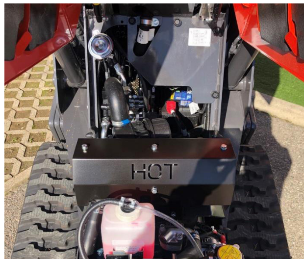
Vorderer Zugang zu Motor, Luft- und Kraftstofffilter.
