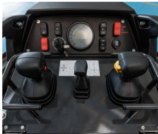
Steuerkonsole mit vorgesteuerten hydraulischen Joysticks.
